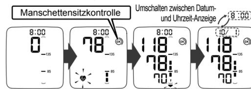
▲ START ▲ AUFPUMPEN ▲ ABLASSEN ▲ FERTIG
